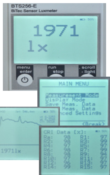
* 照度分光分布をハンドヘルドのディスプレイで即確認
